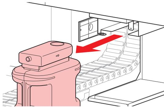
5 取り外した廃インクタンクにキャップをはめて、テープなどを使用して廃インクが漏れないように処理する。
